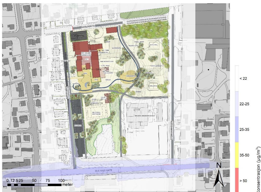
Figur 6. Spredningskart som viser modellerte konsentrasjoner av svevestøv ( \text{PM}_{10} ) som 8. høyeste døgnmiddel ved planområdet for Halsen skole for planforslaget. Landskapsplanen for tiltaket (Agraff Arkitektur, 2022) er vist som bakgrunnskart. Grensene for gul og rød sone i Retningslinje T-1520 tilsvarer maks. 7 overskridelser av hhv. 35 og 50 \mu\text{g}/\text{m}^3 som døgnmiddel.
