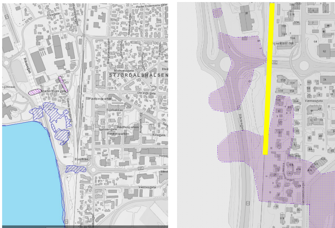
Figur 8: Til venstre, kartutsnitt som viser flomsoneer Stjørdalselva ved 200-års gjentakintervall, i form av lokalt lavpunkt under planområdet, i vegbanen til E14. Til høyre, kartutsnitt som viser den delen av NVE aktsomhetskart som overlapper med planområdet (lengde på planområdet er markert med gul strek).
