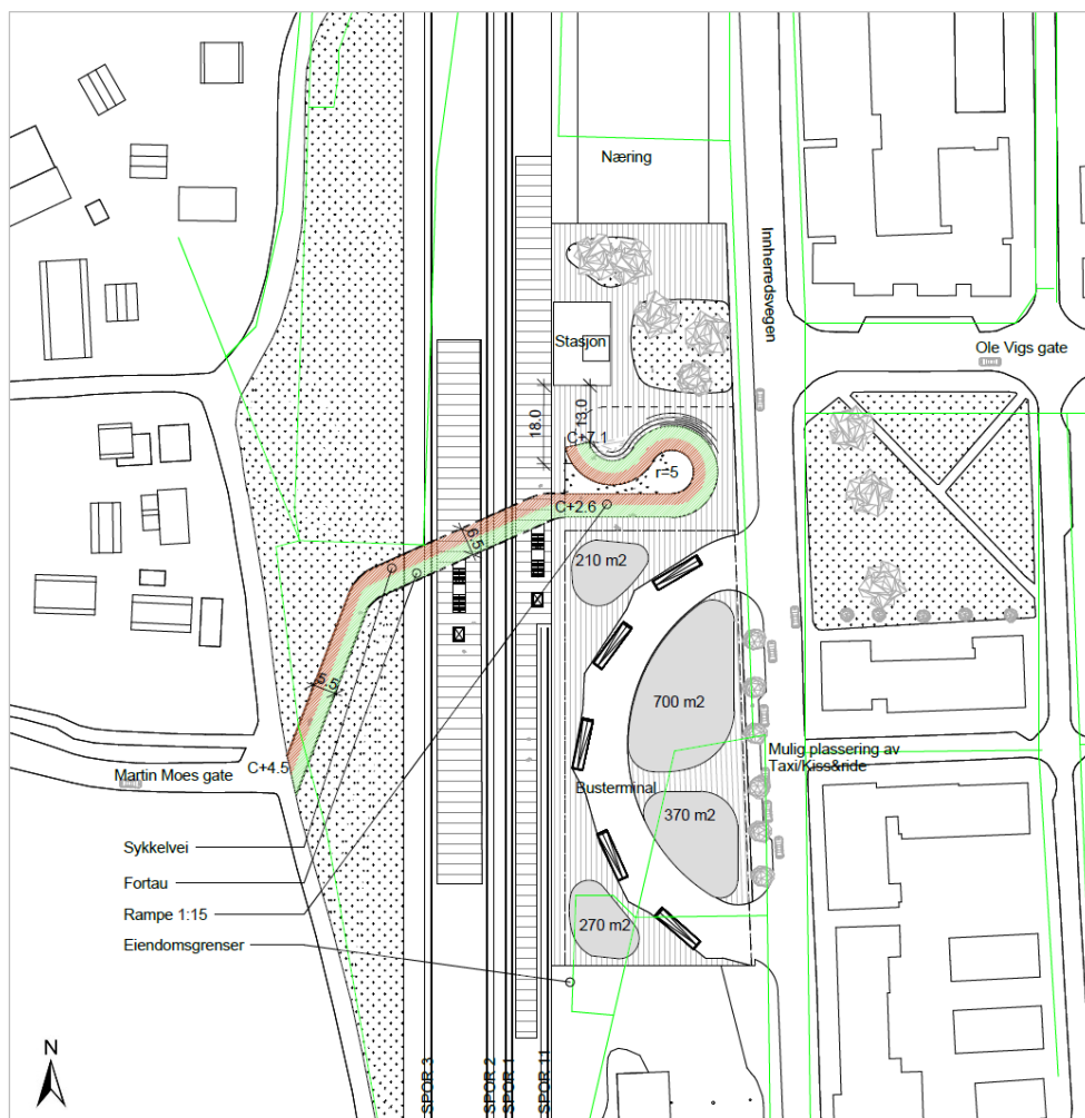
Figur 4: Skisse som viser en mulig utforming av kulvert med ramper og trapper på Stjørnal stasjon som planforslaget gir mulighet for å bygge. Endelig plassering og utforming må tilpasses til framtidig knutepunktutvikling på øst- og vestsiden, som avklares i områderegeringsplanen for Stjørnal stasjonsområde. Illustrasjonen er et forslag og ikke en ferdig prosjektert løsning. Illustrasjon: COWI/Arkitema
