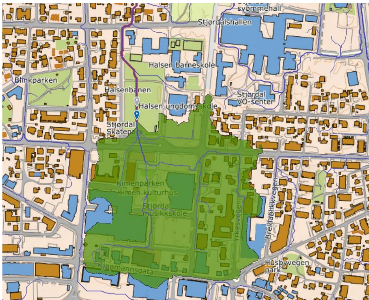
FIGUR 7 OVERSIKT OVER LOKALE OVERVANNSFLOMVEI MED NEDSLAGSFELT
