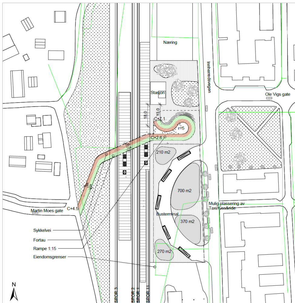
Figur 4: Skisse som viser en mulig utforming av kulvert med ramper og trapper. Illustrasjonen er ikke juridisk bindende. Endelig plassering og utforming må tilpasses til framtidig knutepunktutvikling på øst- og vestsiden, som avklares i områdereguleringsplanen for Stjørdal stasjonsområde. Illustrasjon: COWI/Arkitema
