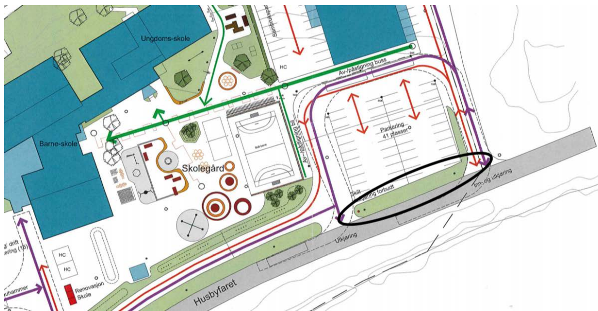
Rekkefølgekrav fortau langs Husbyfaret. (Planområdet ligger til høyre).
