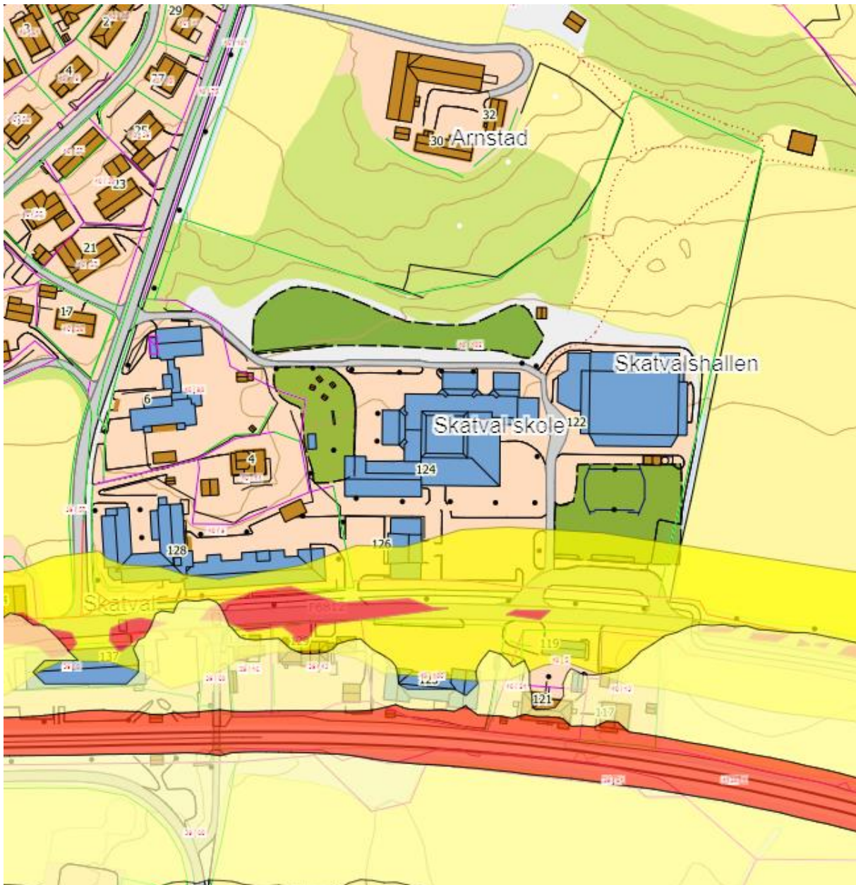
Figur 10 Støysoneskart for jernbane og veg. Gult er støy over 55 dBA og rødt støy over 65 dBA for veg. Tilsvarende tall for bane er 58 og 68 dB.
