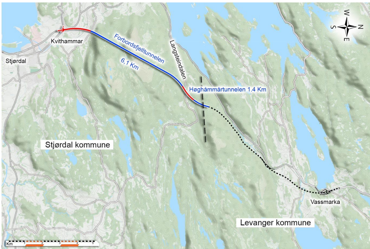
Figur 3 Oversiktskart over ny E6 Kvithammar - Åsen. De fire delstrekningene i Stjørdal er fargelagt, med rød farge for dagstrekninger, blå farge for tunnelstrekninger.
