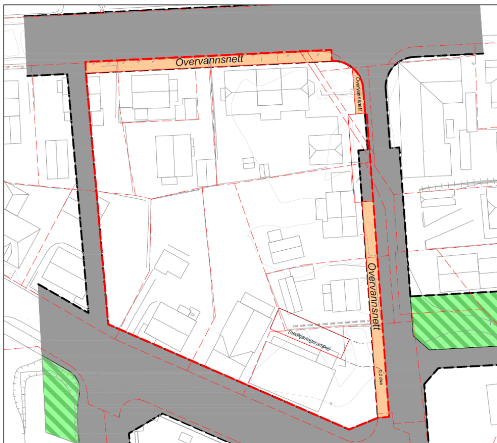
Figur 4-22: Regulering av volum for fordrøyning under bakkenivå, vist på gjeldende områdeplan – under bakkenivå
