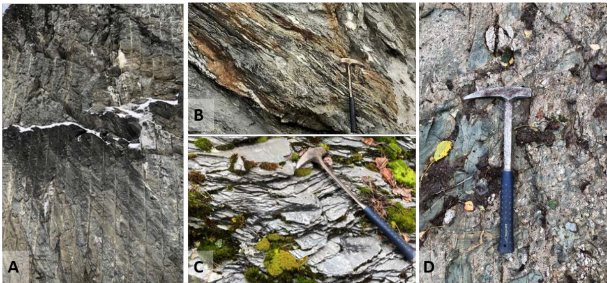
Figur 16. Bergarter langs Hommelvikskjæringa. A: Gråvakke i veksling med fyllitt/leirskifer. Skjæringa på bildet er omkring 20 m høy. B: Sone av fyllitt eller leirskifer (bak hammer) i mer massiv gråvakke. C: Berg klassifisert som leirskifer, sterkt forskifret. D: Konglomerat. Bildet er tatt i terrenget ca. 100 m øst for eksisterende bergskjæring.
