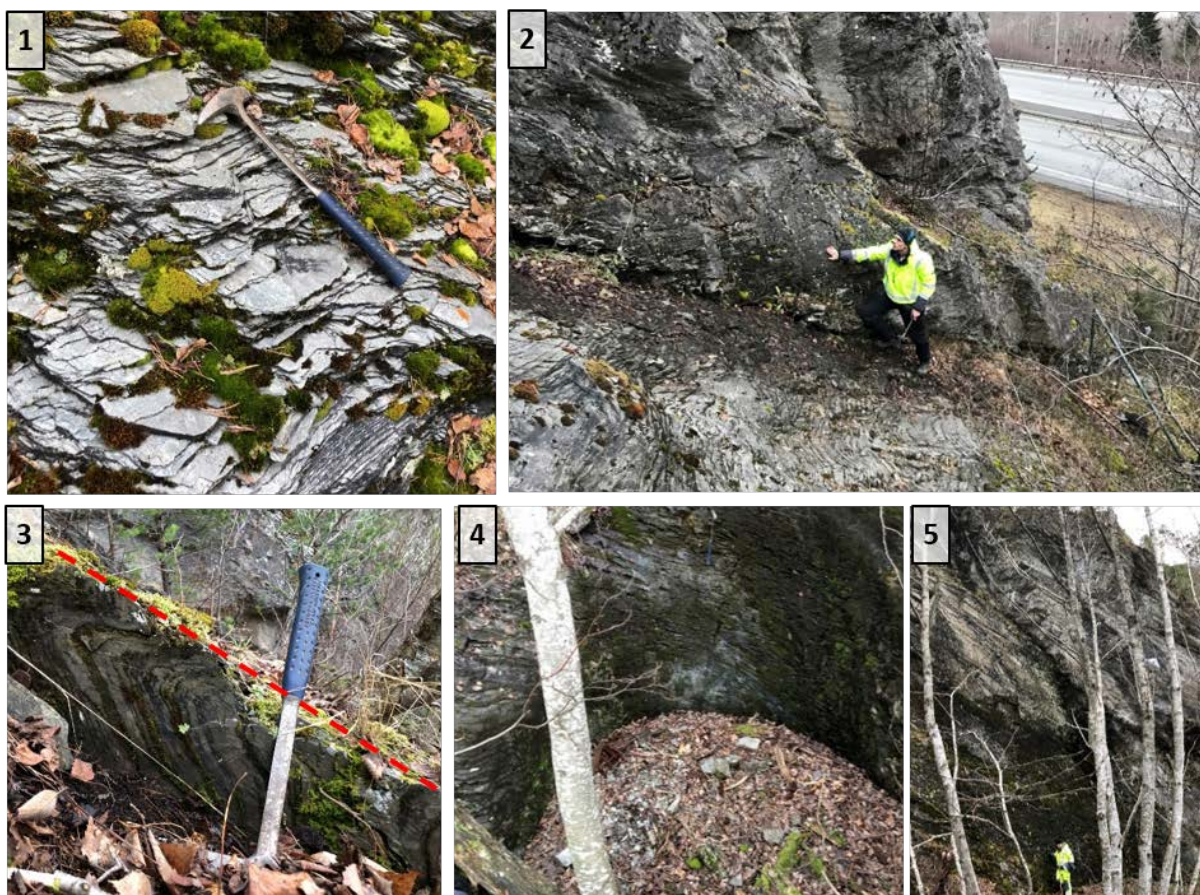
Figur 26. Nummereringen av bildene i figuren korresponderer med nummereringen i Figur 25. Bilde 2 og 3 viser glideplanet langs C (Figur 25). Bilde 1 viser potensielt glideplan like nord for dette. Bilde 4 og 5 viser strukturer og naturlig bergskrent.
