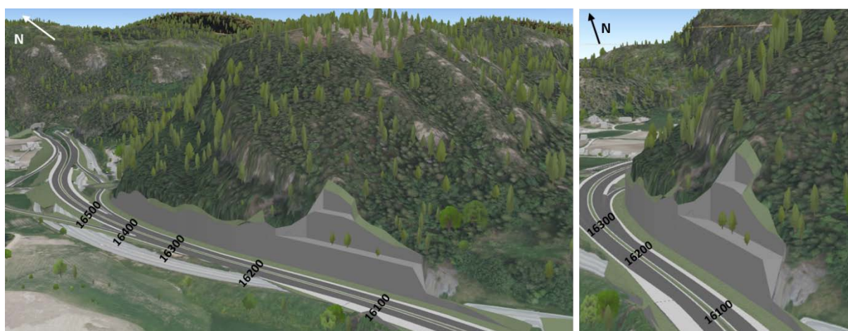
Figur 29. 3D modell av den prosjektert Hommelvikskjæringa. I modellen er hyllebredde 10 m, og pallhøyde 20 m i områdene der det er hylle. På profilnummer høyere enn 16200 er skjæringshøyden inntil 30 m.
