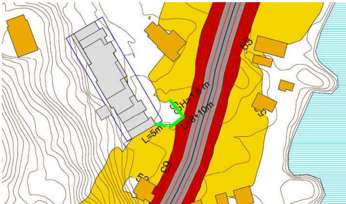
Figur 6. Støysonekart med støyskjerm, 1,5 meter over terreng.
