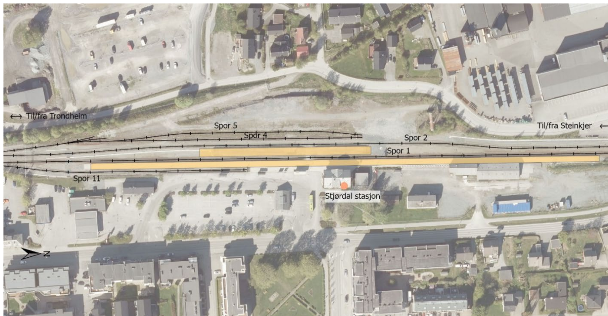
Figur 8: Skjematisk sporplan for eksisterende Stjørdaal stasjon. Spor 1, 2 og 11 er i drift. Fargede områder er plattformer. Spor 4 og 5 er frakoblet og ikke i drift. Illustrasjon: COWI.
