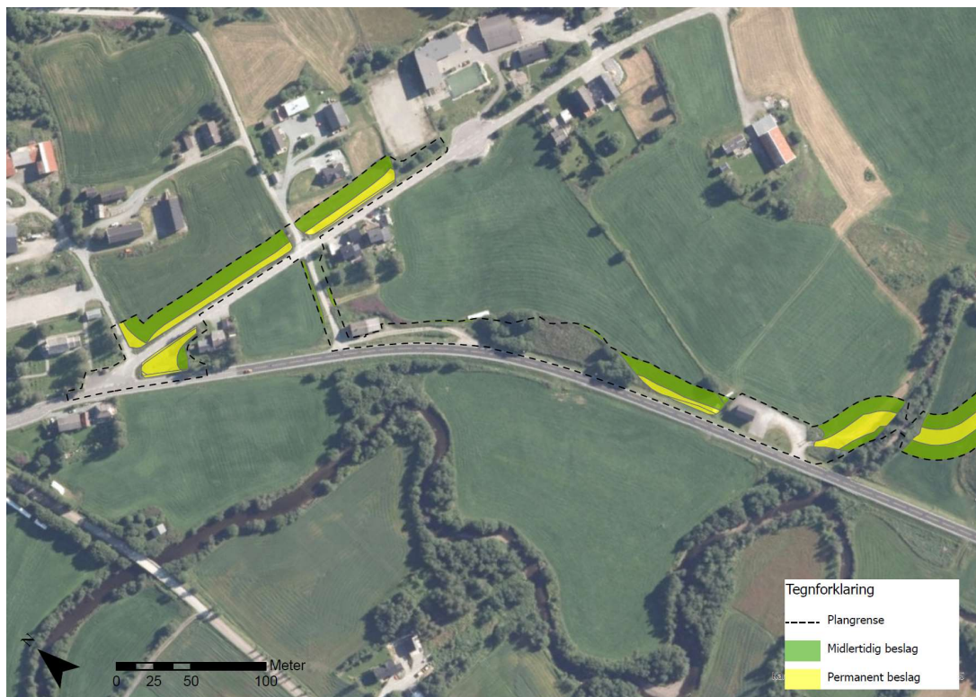
Figur 6-1 Permanent beslaglagt og midlertidig beslaglagt areal for dyrka mark. Ikke justert for endring av snarveg.
