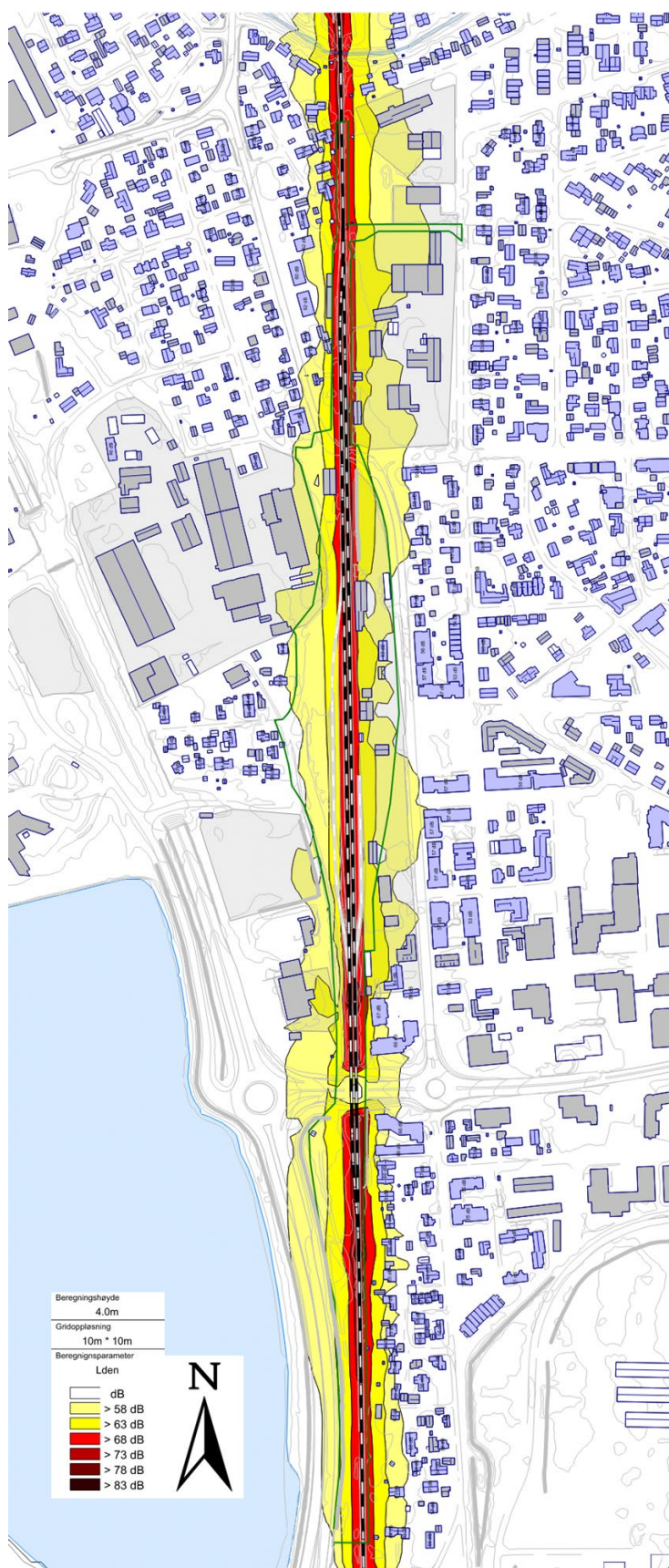
Figur 6 Utsnitt fra støykart X121 – Framtidig situasjon og togtyper – som viser områder med overskridelse av anbefalt grenseverdi i 1,5 m høyde.
