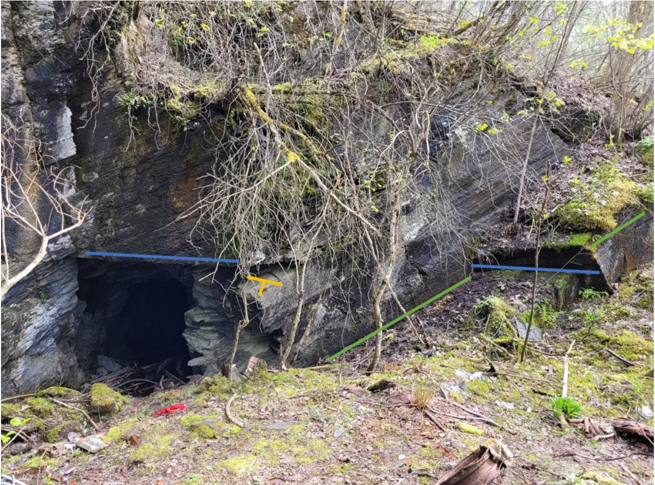
Figur 8 Bilder som viser representative sprekkesett for bruddet markert med blå og grønn strek, samt foliasjonen markert med i gul strek.
