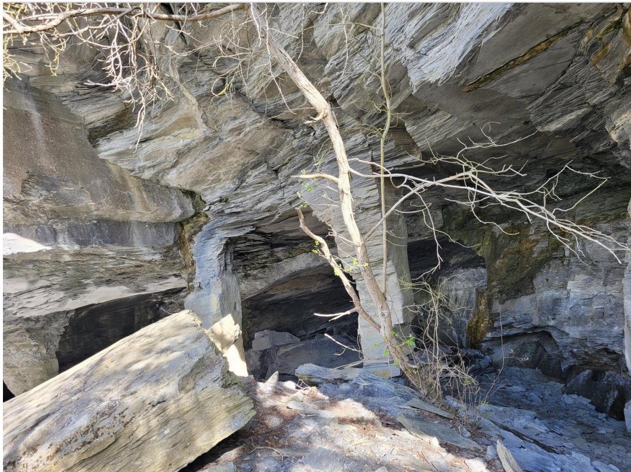
Figur 11 Bilde av hovedskiferbruddet som viser pilarer samt nedfall av blokker og stein i bruddet
