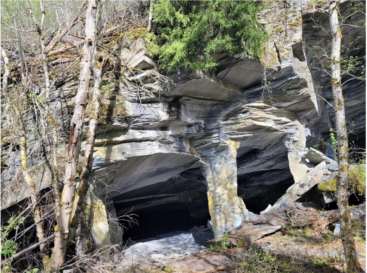
Figur 10 Bilde av hovedskiferbruddet som viser pilarer samt nedfall av blokker og stein i bruddet
