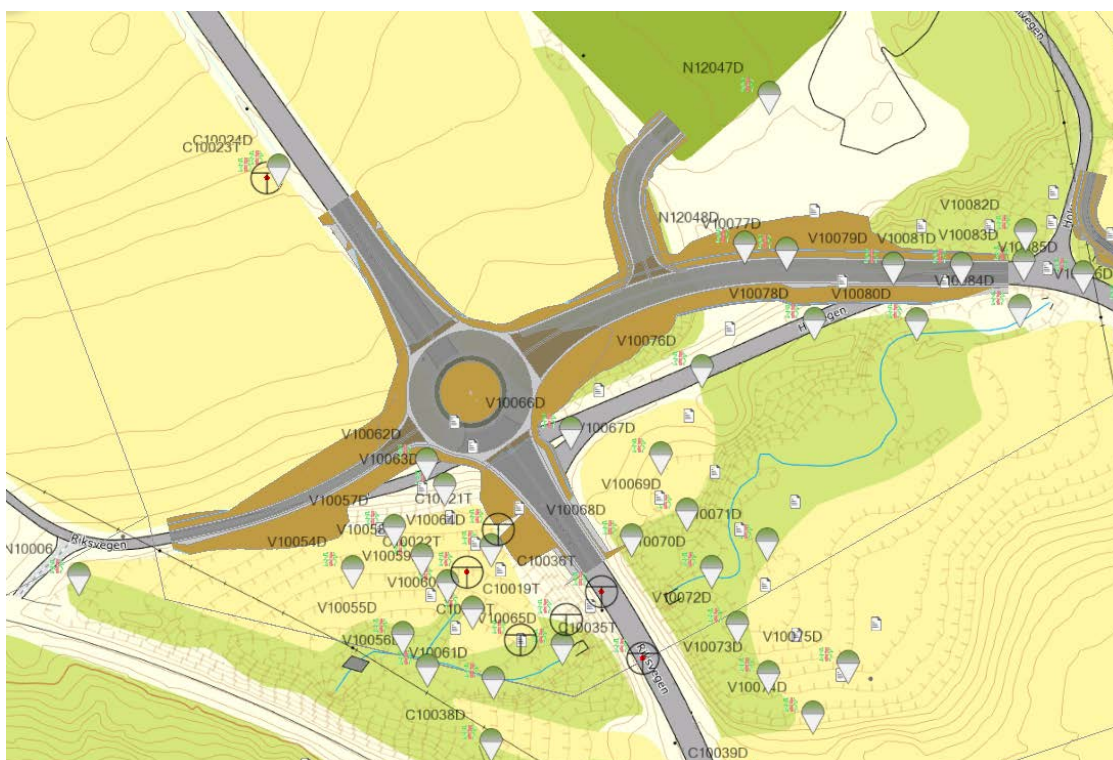
Figur 16: Rundkjøringa og utførte grunnundersøkelser.
