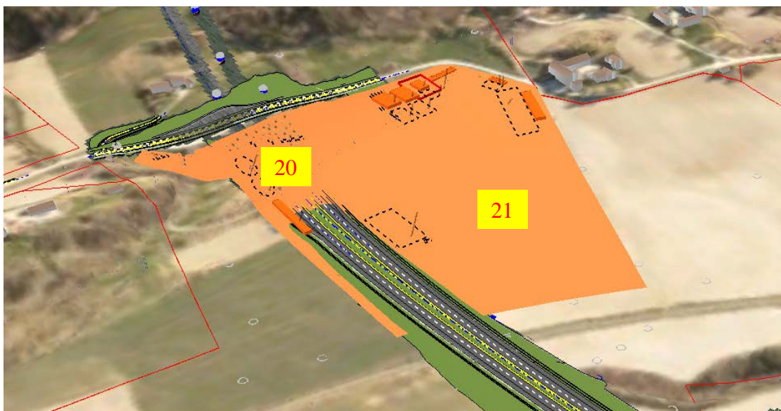
Figur 13: Perspektiv fra modell, hvor området tiltenkt etablering av tunnelrigg er markert med oransje. Plassering av telthaller er vist på figuren, men dette må tilpasses grunnforholdene og prosjekteres i byggeplan.
