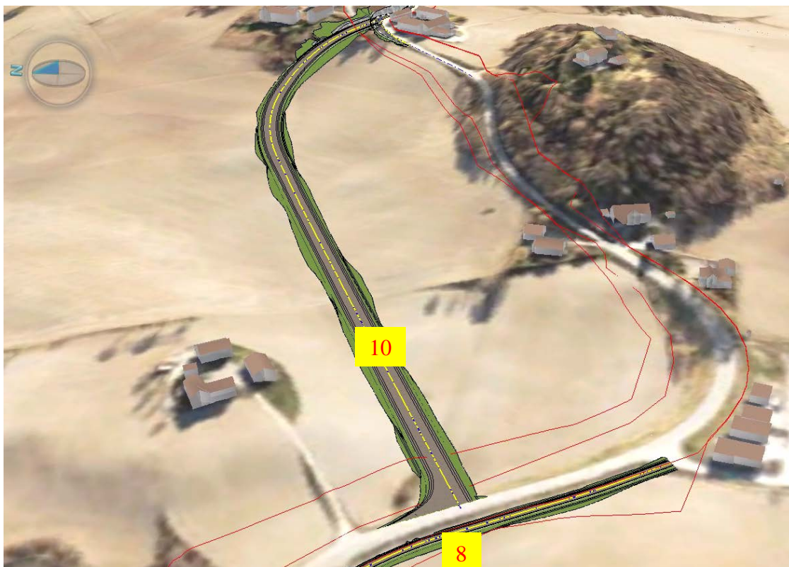
Figur 8: Alternativet med midlertidig anleggsveg over jordet, sett fra vest. Dersom anleggsvegen bygges, er det for å redusere trafikkbelastningen på boligene til høyre på figuren.
