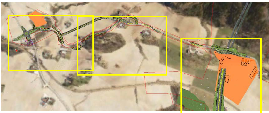
Figur 1: Planen starter i vest med ny rundkjøring på E6 og et riggområde for entreprenøren som skal utføre arbeidene. Deretter en ca. 200 m lang gang- og sykkelveg. Forbi Holthaugen velges enten en anleggsveg over jordet eller trafiksikkerhetstiltak langs Holvegen. Fra Holan til øvre Holan planlegges breddeutvidelser og avkjørsler. Ved Forbordsfjelltunnelen planlegges det etablert et riggområde for tunneldriften og uttak av forskjæring. Gule rammer viser utsnittene som er vist i Figur 2, Figur 3 og Figur 4.
