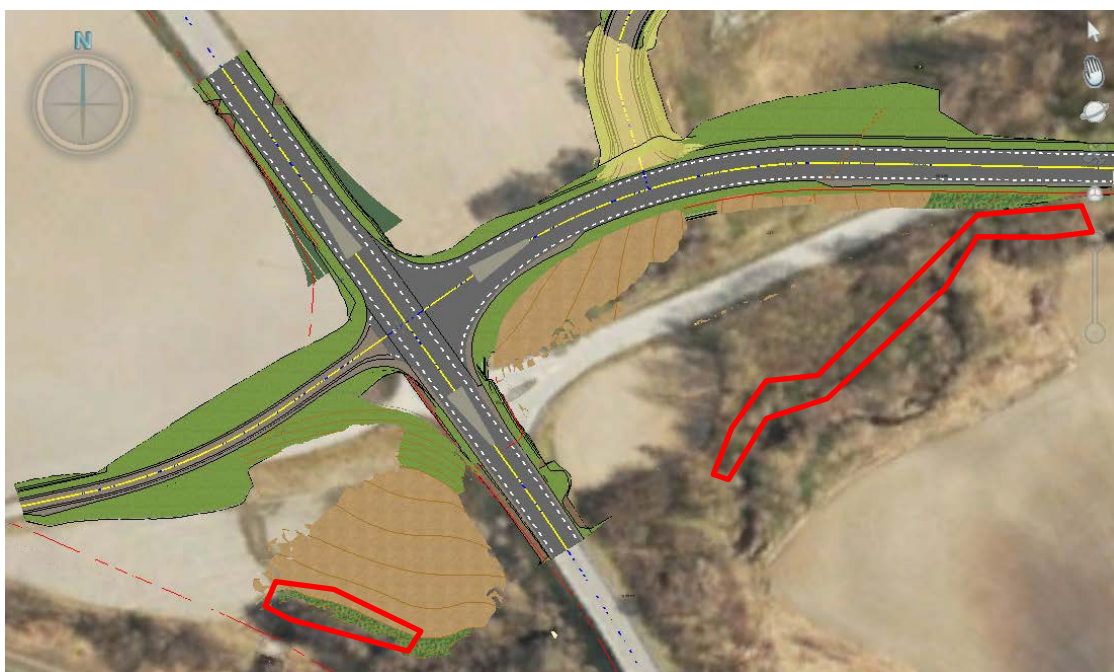
Figur 6: Ved anleggets slutt planlegges det å tilbakeføre krysset til et T-kryss og avkjørsel. Omfang erosjonssikring er skissemessig vist med røde polygoner.
