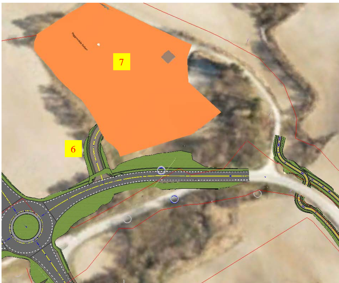
Figur 12: Det planlegges ny adkomstveg til riggområdet øst for rundkjøringen.
