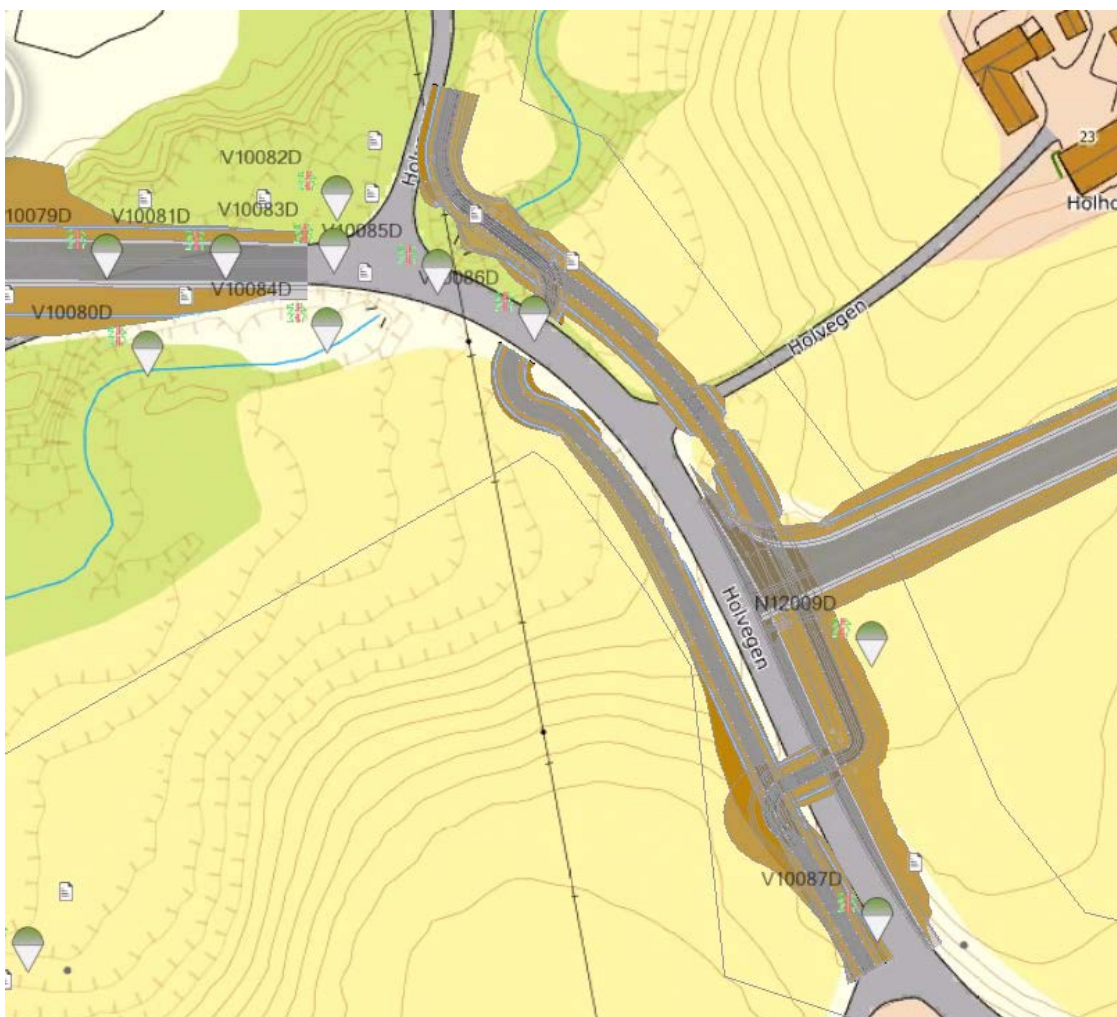
Figur 17: Ett av to gang- og sykkelveg-alternativer skal bygges. Det er utført grunnundersøkelser langs traseen.
