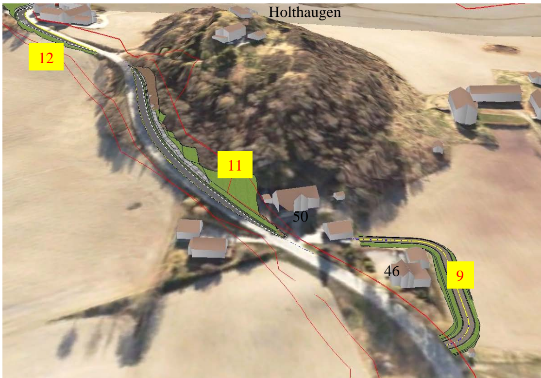
Figur 9: Felles avkjørsel for Holvegen 46 og 50 bak Holvegen 46. Breiddeutvidelse av Holvegen med skjæring i Holthaugen.
