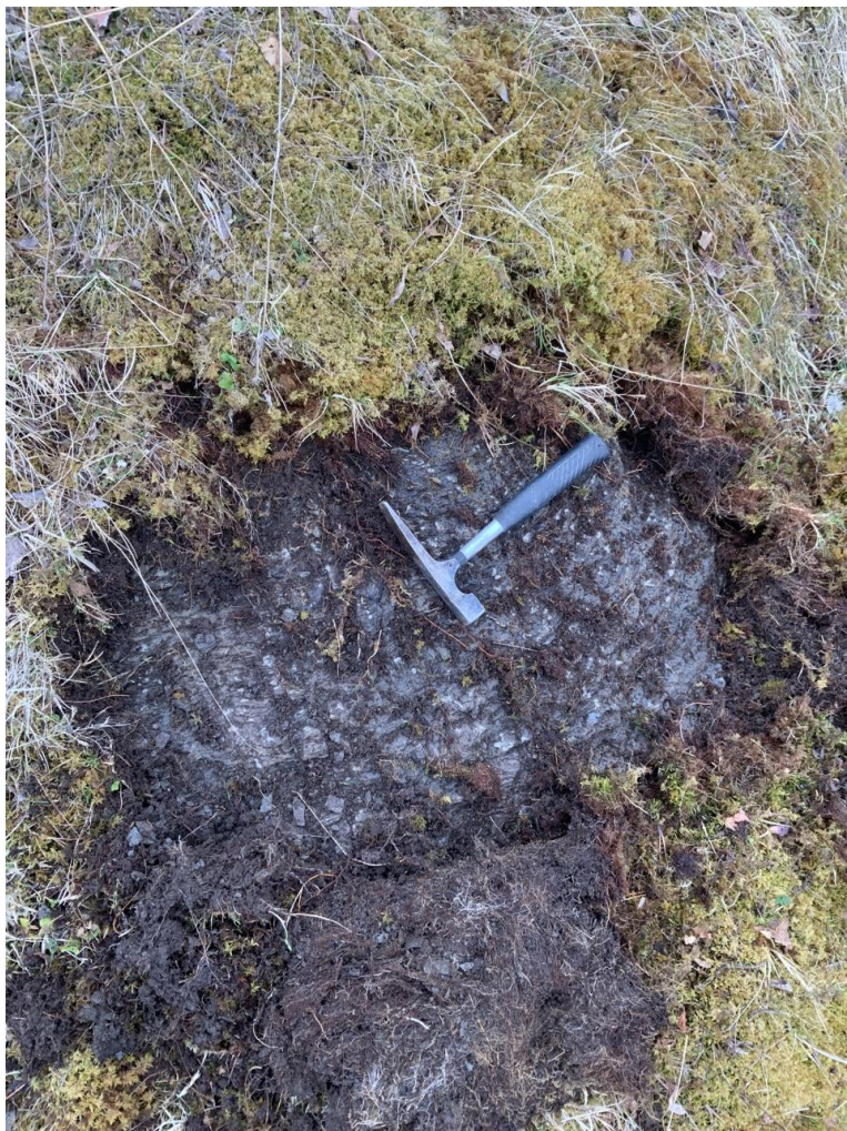
Bilde 7: Bergblotning ved østlig side av Furukollen, tynt løsmassedekke.
