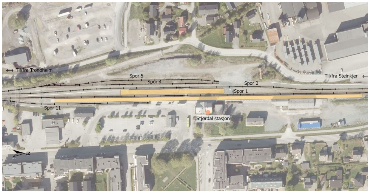
Figur 8: Skjematisk sporplan for eksisterende Stjørdal stasjon. Spor 1, 2 og 11 er i drift. Fargede områder er plattformer. Spor 4 og 5 er frakoblet og ikke i drift. Illustrasjon: COWI.
