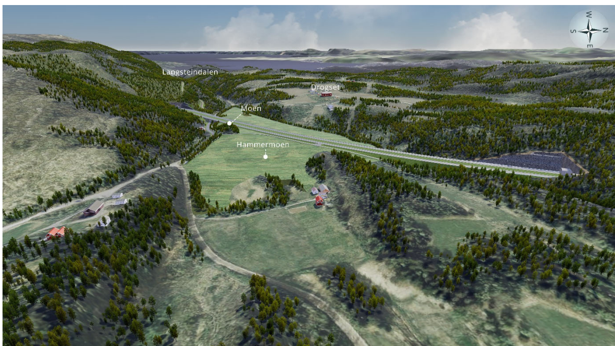
Figur 56: Luftperspektiv sett fra øst mot vest. Den 1 070 m lange E6 traséen går diagonalt gjennom den vestre del av dalrommet, i en slak kurve, som til en viss grad følger landskapets retning. Ny E6 medfører at jordbrukslandskapet blir delt i to og mer homogen. Både Langsteinvegen og Langsteinelva, som er eksisterende linjer som følger landskapets retning, brytes av ny E6-trasé. Påhugget til Forbordsfjelltunnelen kan så vidt skimtes til venstre, mens Høghåmmårtunnelens påhugg er godt synlig til høyre i illustrasjonen.
