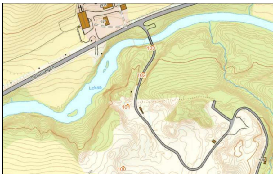
Figur 29. Grunnundersøkelser og borpunktene plassering. Punkt 100, 101, 102 og 103.
