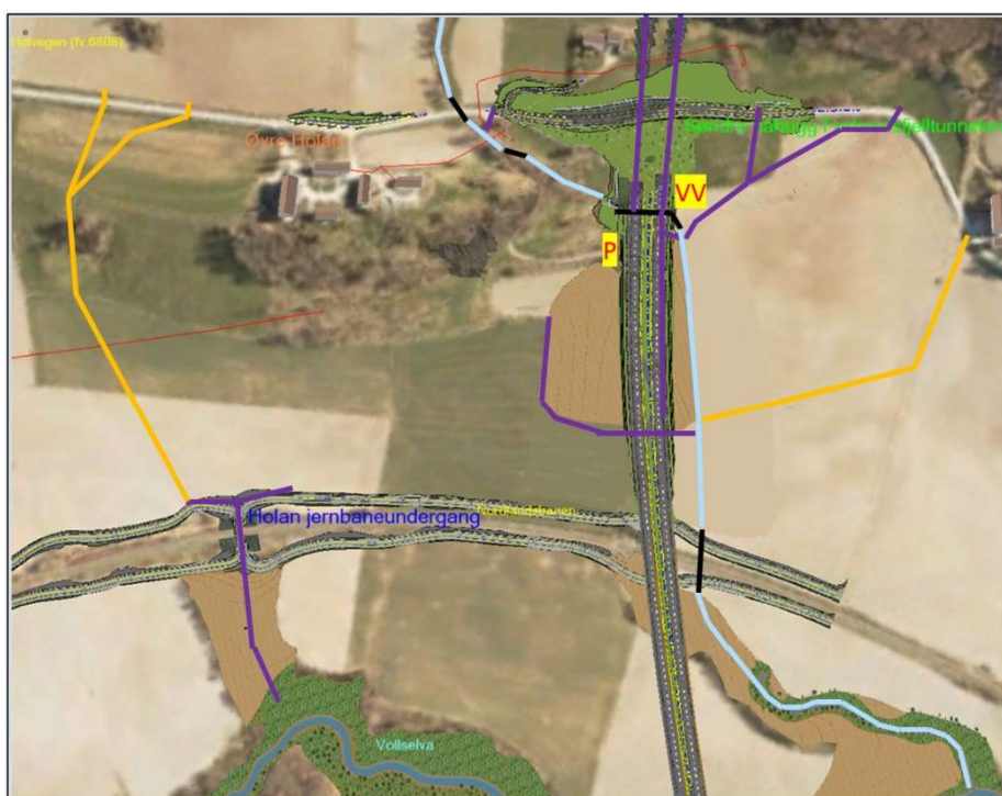
Figur 10: Alternativ 2D, forlenget bru med bekk inntil bru og tilløpsfylling. (illustrasjonen er ikke oppdatert med kantvegetasjon)
