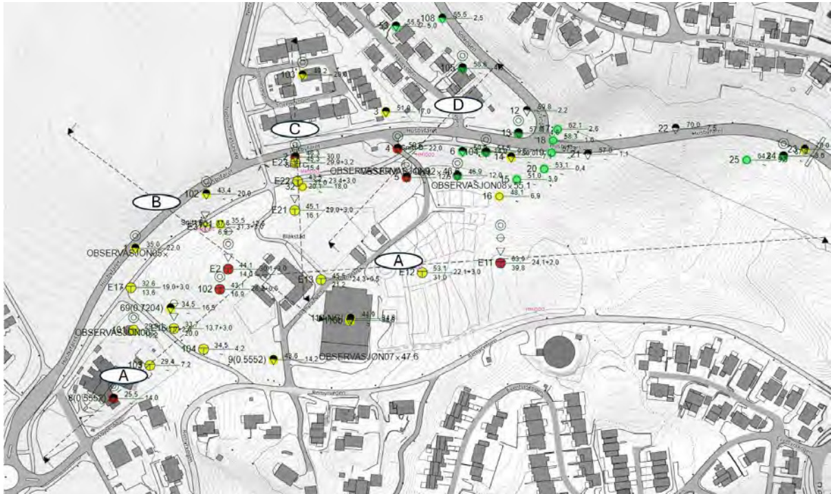
Figur 19 Avmerking av kritisk snitt, og tilgjengelige grunnundersøkelser
