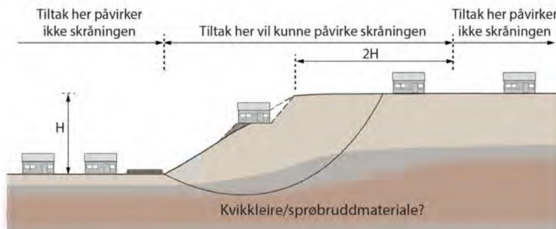
Figur 3.4 Terrengsnitt som viser prinsipp for når en skråning kan vurderes upåvirket av tiltaket (utenfor tiltakets influensområde).
