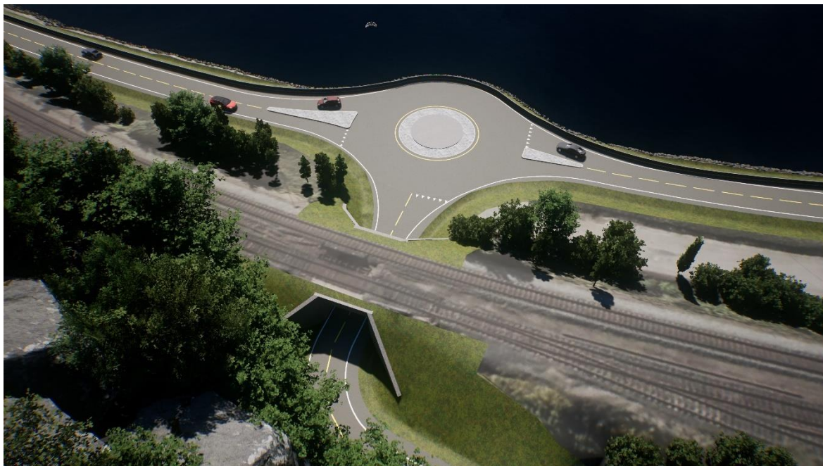
Figur 32: Rundkjøring og tilhørende steinfylling i sjø er midlertidig tiltak for anleggsfasen tilknyttet bygging av ny E6 Kvithammar- Åsen, som skal fjernes etter anleggsslutt. Senkning av veg, ny kulvert og møtelommer langs Langsteinvegen er permanente tiltak som ikke fjernes.
