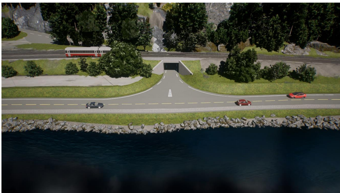
Figur 33: Rundkjøring med tilhørende fylling i sjø skal fjernes og vegen skal tilbakeføres som T-kryss ved anleggsslutt tilknyttet E6 Kvithammar - Åsen.
