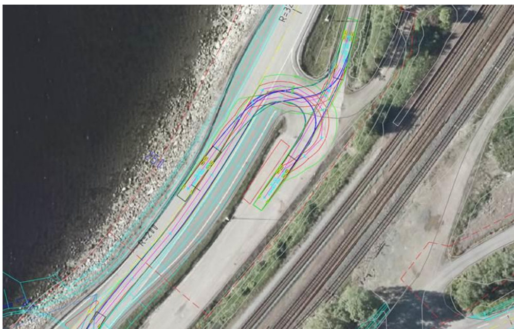
Figur 44: Sporing av vending for buss. Kjører inn på plass og plukker opp skolelever før rygging.
