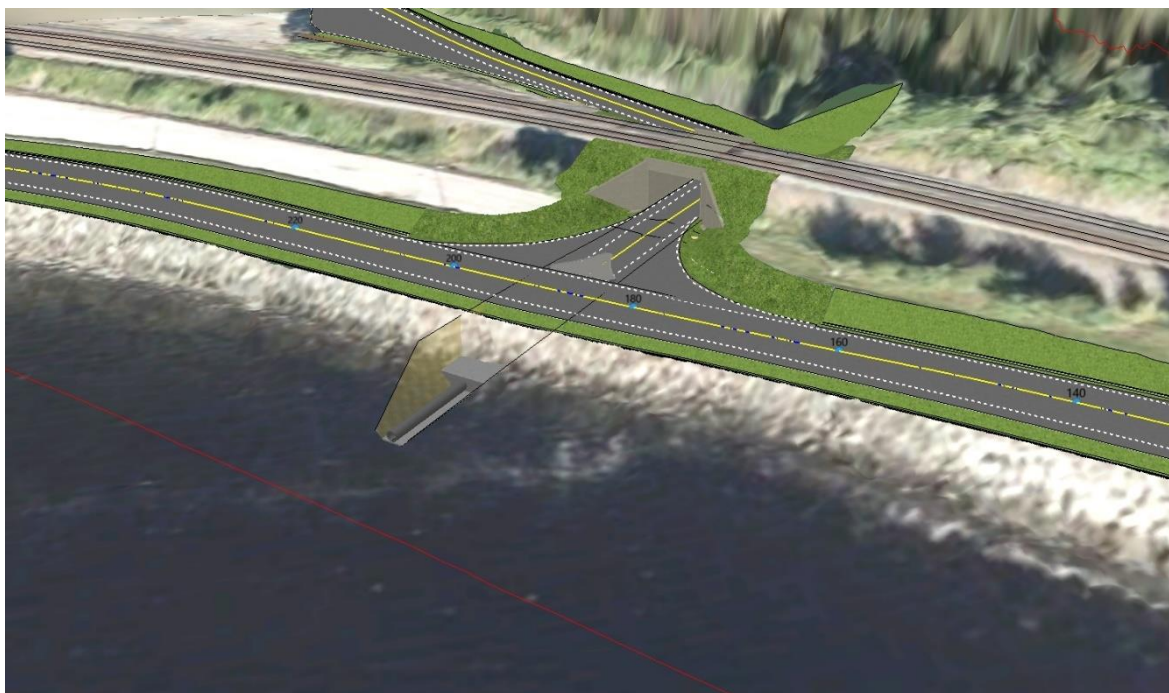
Figur 34: Overvannsledning ut i sjø, som vist i permanent situasjon (Kilde: BIM-modell, Forprosjekt Langstein 01.11.2018).
