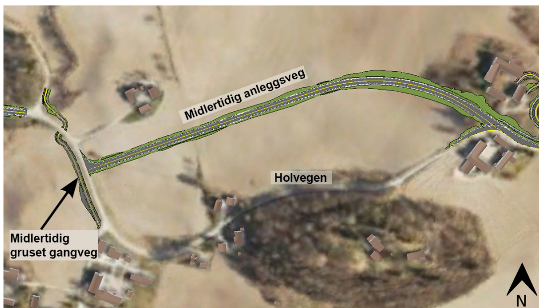
Figur 4 Midlertidig anleggsveg og midlertidig gruset gangveg
