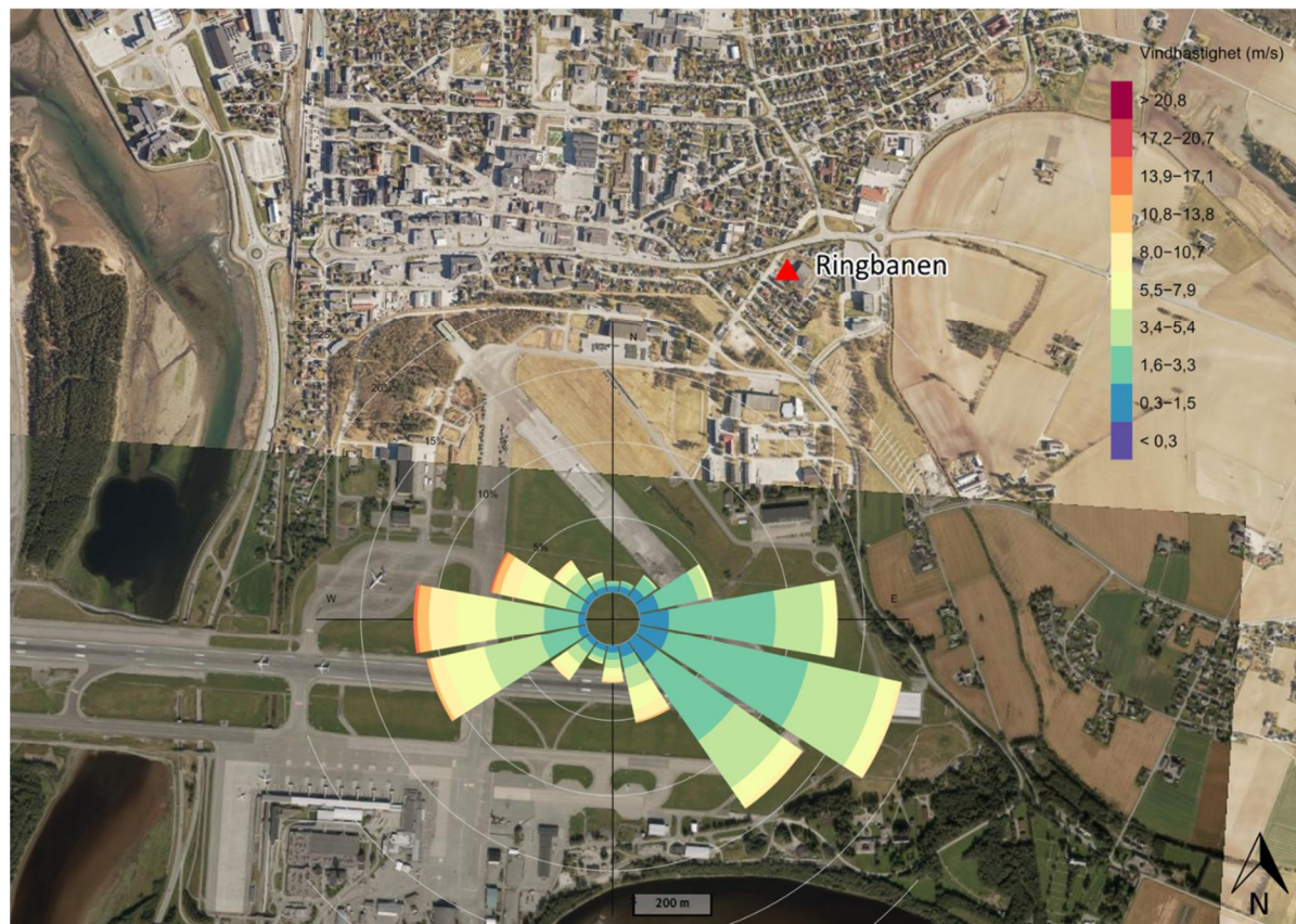
Figur 5. Kart som viser vindrose for Værnes meteorologiske stasjon i Stjørdal kommune for perioden 2008-2017, og plassering av stasjon i forhold til planområdet ved Ringbanen. Vindrosen viser frekvensfordelingen av vindhastigheter i prosent, og vindretninger fordelt på sektorer på 30°. Vinddata er hentet ut fra eKlima (Meteorologisk institutt, 2018), og kartgrunnlag (ortofoto) fra norgeskart (Kartverket, 2018).
