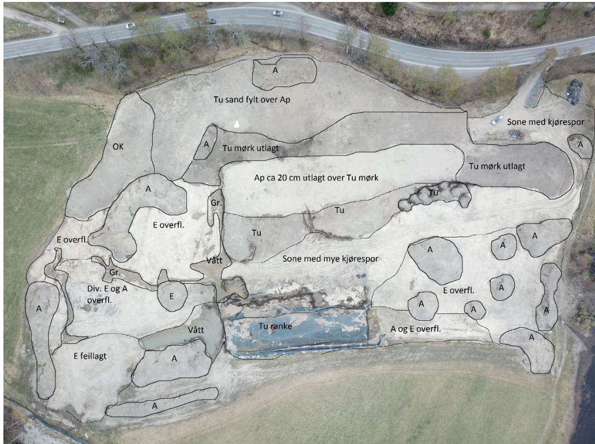
Figur 9 Oversikt over området for avvanning av mudringsmasser på Bogstad under tilbakeføring til jordbruksareal 03.05.2019 (A=ploglagsmasser, Tu=avvannede masser).
