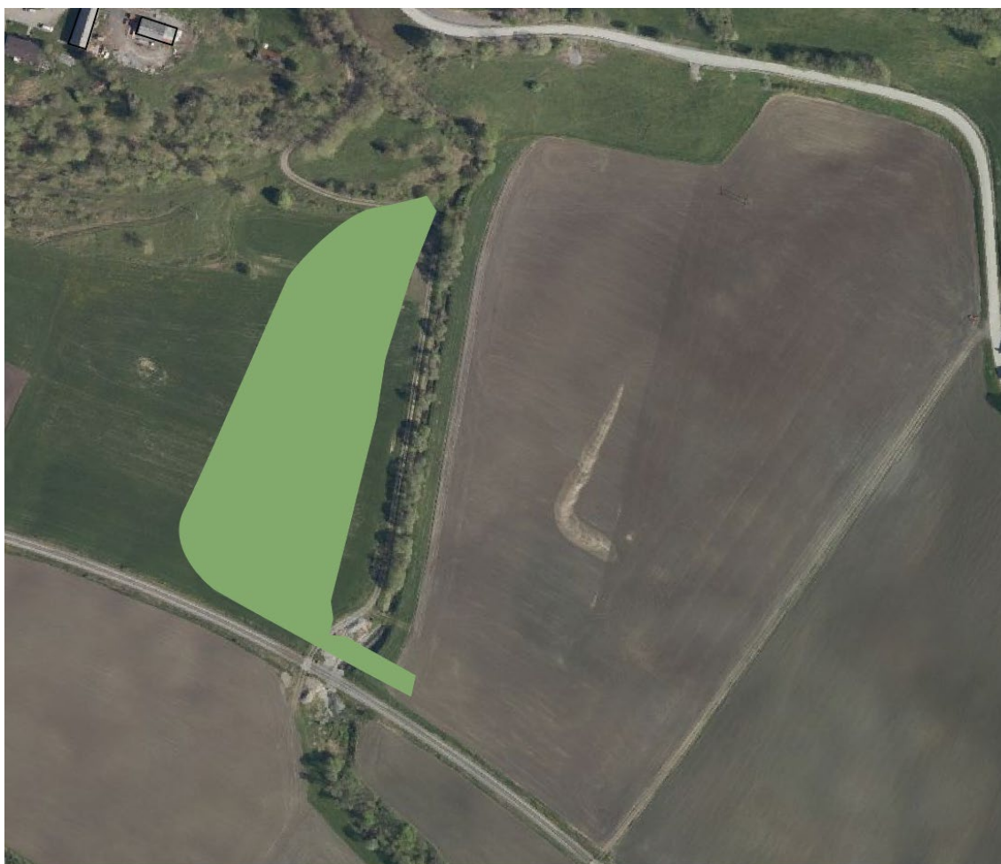
Figur 19 Utforming av jordbruksareal på fylling av tunnelmasser nord for jernbanelinja på Holan.
