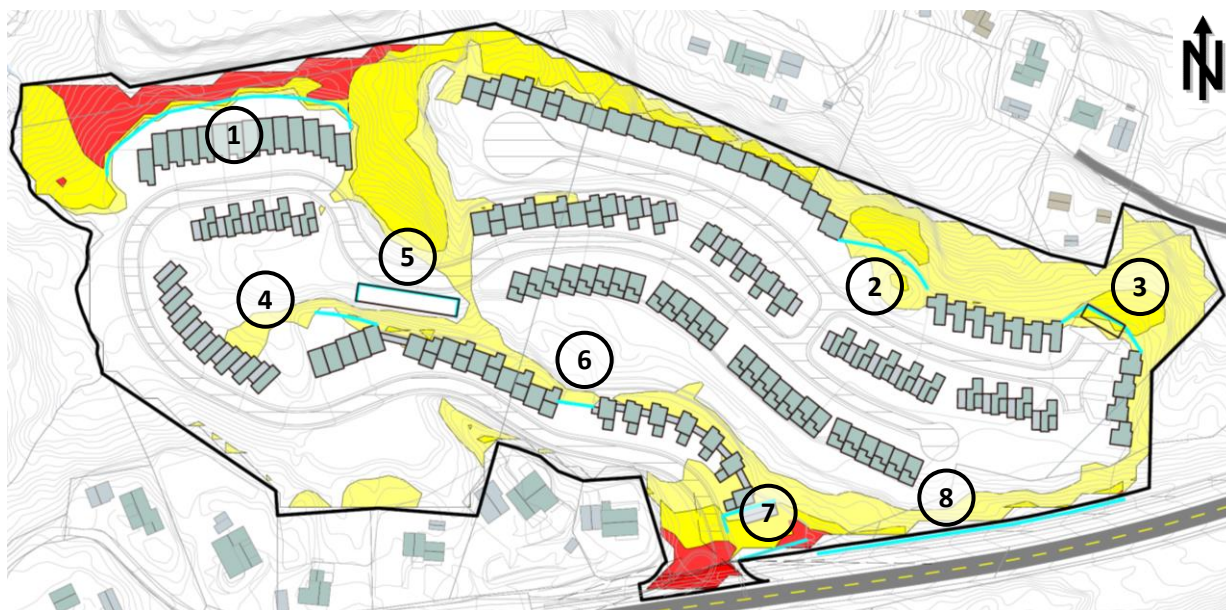
Figur 5 Nummerering av de forskjellige avbøtende skjermingstiltakene lagt inn i støymodellen for planområdet. Tiltakene beskrives i tabell 9.
