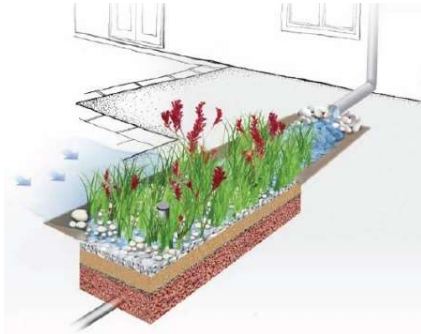
Figur 26: Overvannshåndtering av takvann
