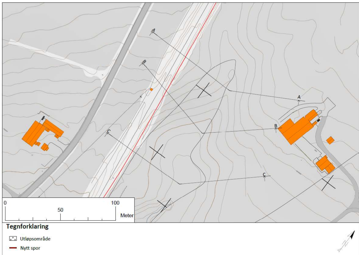
Figur 4.13 Snitt for å analysere mulighet for kanalisering av skred.
