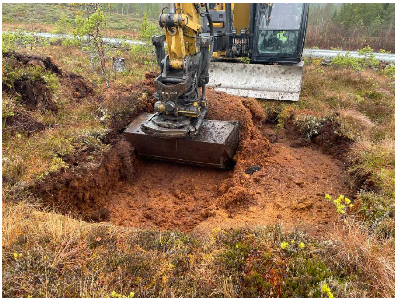
Figur 14. Prøvegraving ved lokasjon 3, de lyse oransjefargete massene er fibrig masse som utgjør høymyr med et meget høyt vann innhold 93%
