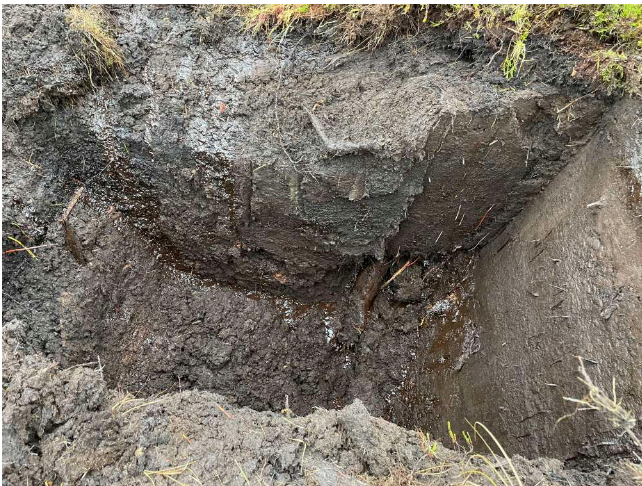
Figur 15. Prøvegraving lokasjon 2. Massene består av organisk mørk mineral jordder plante materialet i stor grad er omvandlet og brutt ned, noen stokker ble observert i bunnen av gropen.
