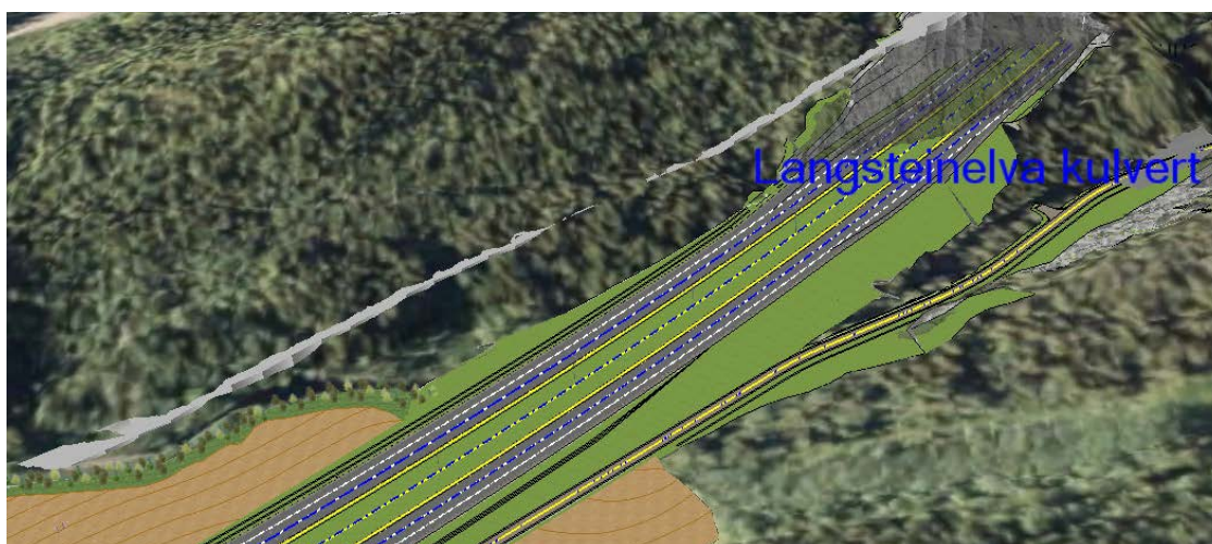
Figur 12 Fylling med helning 1:1,25 ned mot Langsteinelva.
