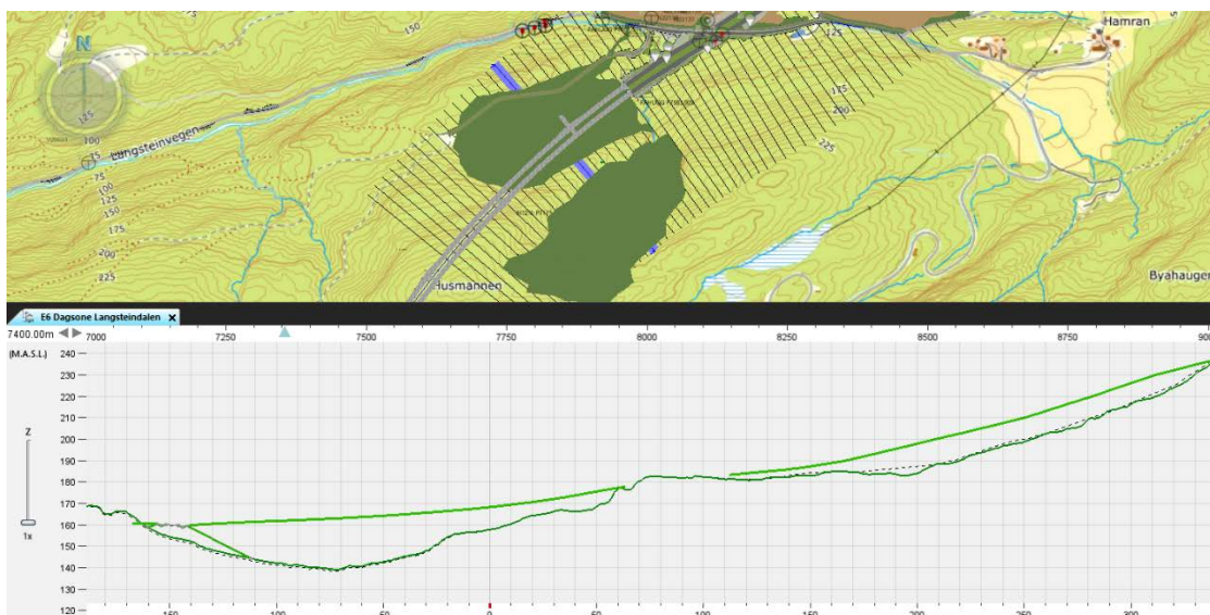
Figur 24 Plan og profil gjennom deponiområder i Langsteindalen.
