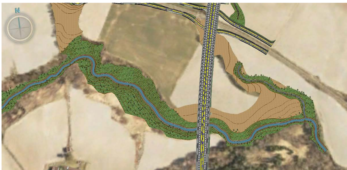
Figur 29 Planskisse av Vollselvbrua, heving av Vollselva og terrengtilpasning.
