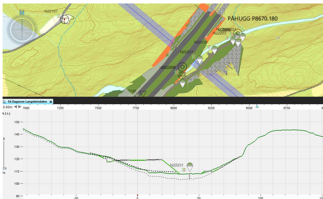
Figur 28 Plan og profil for riggområde (oransje) sør for Høghåmmårtunnelen.
