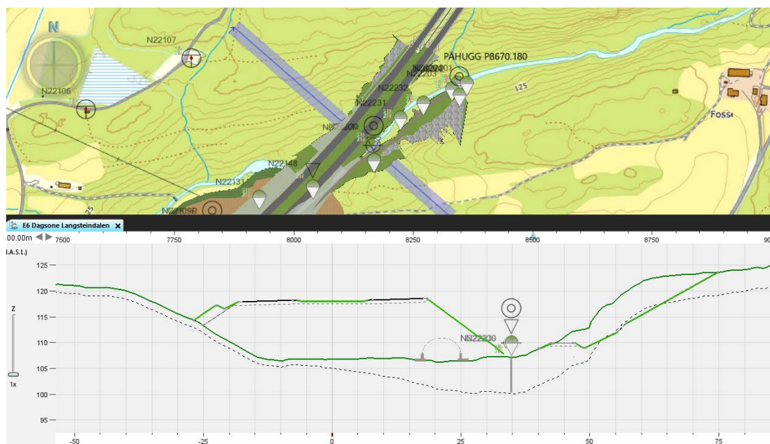
Figur 34 Plan og profil ved Langsteinelva Kulvert.
