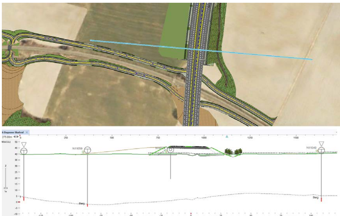
Figur 8 Plan og profil der Vollselvbrua "lander" på tilløpsfylling, ca. 1275 m nord for Kvithammarkrysset.
