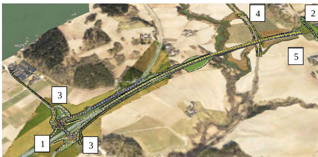
Figur 1 Oversikt over prosjektområdet sør for Forbordsfjelltunnelen. Nede til venstre ses Kvithammarkrysset, mens veglinje fortsetter nordover over Vollselsvbrua og en større fylling før den går inn i Forbordsfjelltunnelen.
