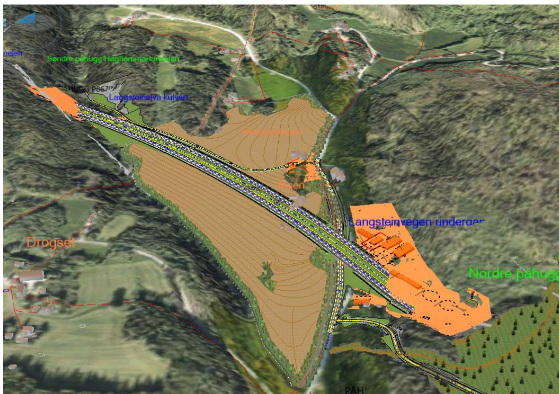
Figur 2 Fylling i Langsteindalen sett fra vest. E6 krysser dalen på fyllingen.
