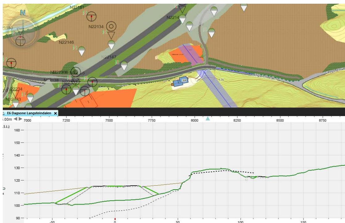
Figur 27 Plan og profil gjennom kontorrigg (oransje) nord for Langsteinvegen.
