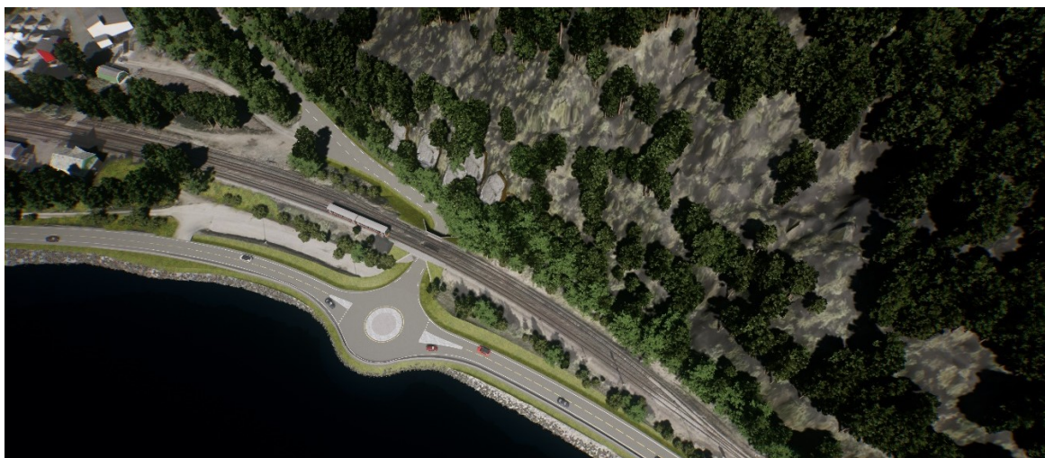
Figur 2: Midlertidig situasjon. Rundkjøring og tilhørende steinfylling i sjø er midlertidig tiltak for anleggsfasen som vil fjernes ved anleggsslutt.
